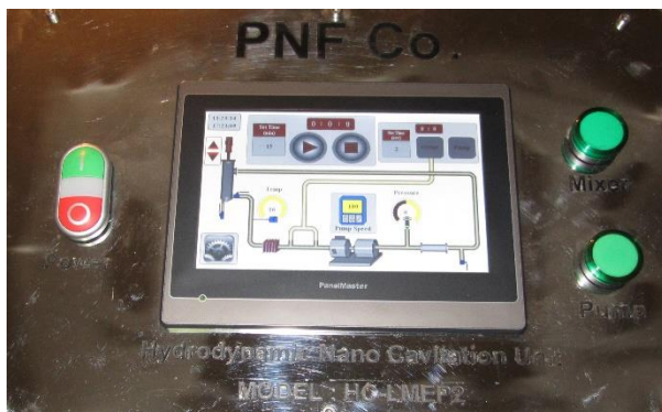
شکل ۴- پنل دستگاه شامل کلید اصلی، صفحه نمایشگر لمسی و چراغ سیگنال
