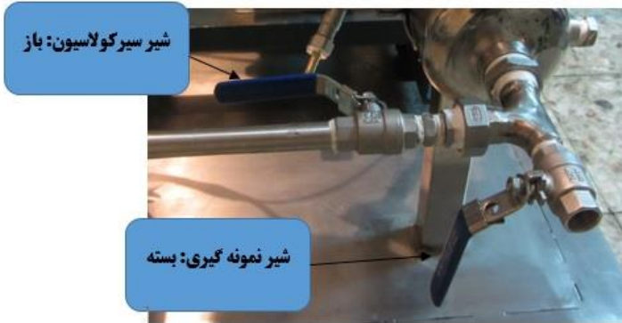
شکل ۳- نحوه قرار داشتن شیرهای دستی برای سیر کولاسیون
