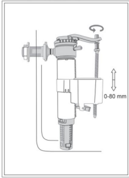
مطابق شکل، میزان آبگیری توسط پیچ
