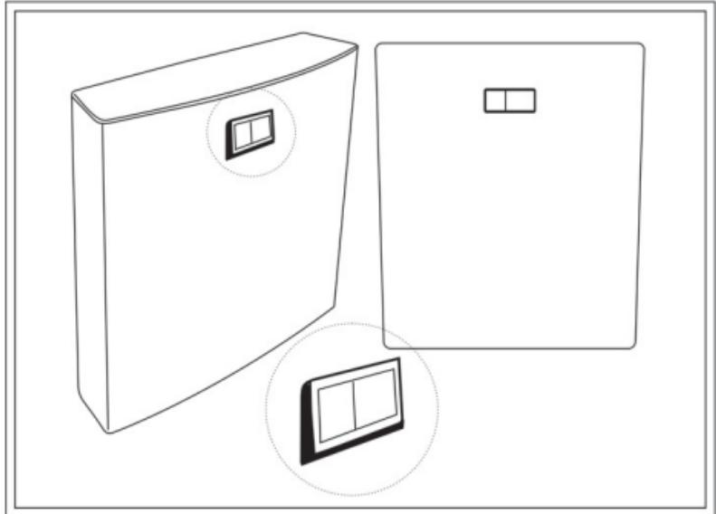
۱. هنگام نصب کلید دقت فرمایید که کلید کوچک مقابله پل تخلیه کم و کلید بزرگ روبروی پل تخلیه بزرگ قرار گیرد
