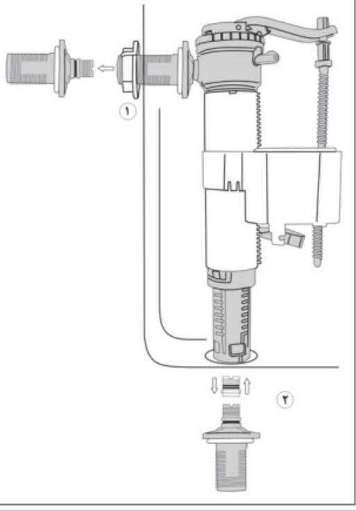
این محصول به گونه ای طراحی شده که به سادگی و فقط با باز و بسته کردن یک قطعه، هم برای آبگیری از کف و هم برای آبگیری از کنار قابل استفاده باشد. نحوه انجام اینکار در ادامه توضیح داده شده است.
