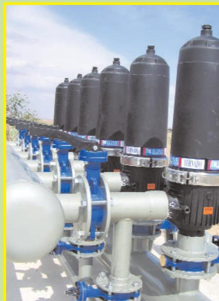
در این فیلترها آب حین عبور از منفذ بسیار کوچک تصفیه می شود. این منفذ ممکن است از به هم پیوستن دیسک ها حول یک محور تشکیل شوند که در این صورت آن را فیلتر دیسکی می نامند و یا سوراخ های ساده ای از یک توری باشند.
