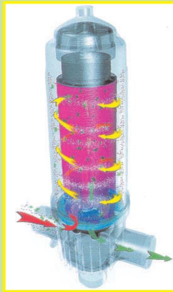
سایز ۲ و ۳ ساخته می شود که تحت دو سیستم کارکرد CIRCULAR و TORNADO تقسیم بندی می شود که تفاوت سیستم های TORNADO به علت وجود توربین در قسمت ورودی این فیلترها می باشد که با حرکت مارپیچی که به جریان آب می دهد باعث می شود ذرات معلق آب از صفحات دیسکی فاصله گرفته و به سمت جداره بدن فیلتر حرکت کند و بدین ترتیب از تجمع ذرات روی جداره دیسک جلوگیری به عمل آید تا در میزان مصرف آب جهت شست و شوی فیلترها صرف جویی به عمل آمده و تعداد دفعات شست و شو نیز کاهش یابد.
