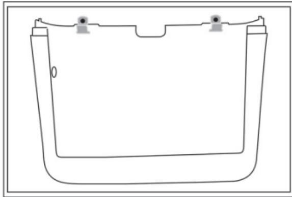
✓ برای نصب بدنه به دیوار حتما از بست فلزی موجود در جعبه ویر اساس الگوی نصب مخصوص هر مدل استفاده نمایید.
