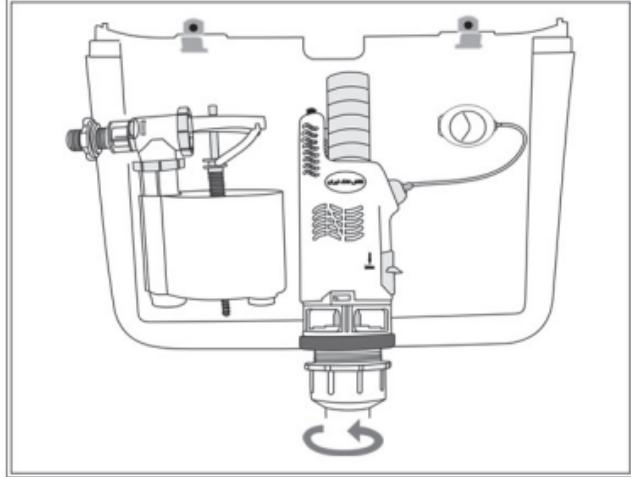
✓ پمپ را درون تانک قرار دهید و مطمئن شوید اورینگ پمپ از سمت دارای دندانه به روی تانک قرار گرفته است، سپس مهره را از زیر تانک بر روی پمپ بچرخانید تا پمپ سر جای خود محکم قرار گیرد.
