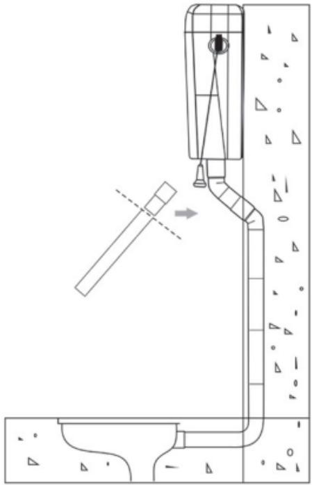
✓ شما می توانید با برش تکه ای از لوله صاف مطابق شکل ، لوله های فلاش تانک خود را به صورت توکار در داخل دیوار قرار دهید.
